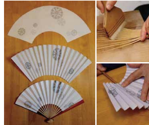
写真左の一番上が、三枚の紙を合わせた平らな扇面。この三枚あわせの真ん中（一枚半のところ）に口をあけ、折り目の付いた型で表裏を挟み折った状態が写真の真ん中の状態。その後、扇骨を差すための穴を開け、糊を塗った扇骨（写真右上）を差し込み（写真右下）、接着するなどの工程を経て完成形となる
