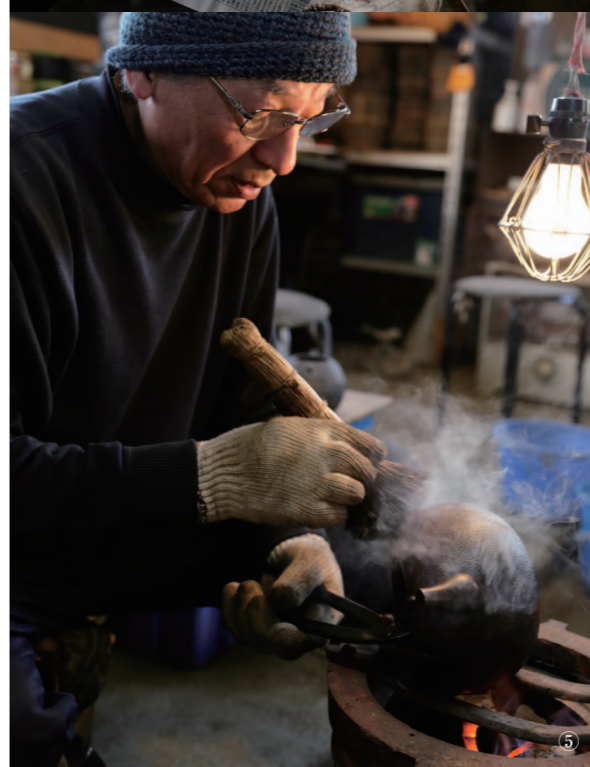
①②中子を入れた鑄型が、上下組み合わせた状態。上部の穴から、溶けた鉄を注ぎます。③注口部分の鑄型と中子が組合わさったもの。④漆とおはぐろ、茶汁を混ぜた液体で着色。⑤熱した鉄瓶に、くごという草で作った『くご刷毛』で着色していきます。音を立てて漆が蒸発するなかでの、作業です。
