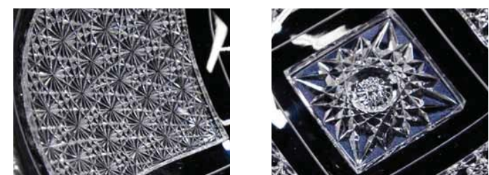
ガラスをカットするには、現在ではダイヤモンドホイールを使用しています。このダイヤモンドホイールに対し、どのような角度で、またどのくらいの力を込めてガラスを当てていくかに、熟練の技が活かされます。
